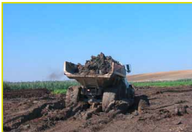
Sur sols peu portants, les risques d'enlèvement sont très importants et engendrent une dégradation de la zone humide (Photo : Agence de l'eau Rhin-Meuse)
