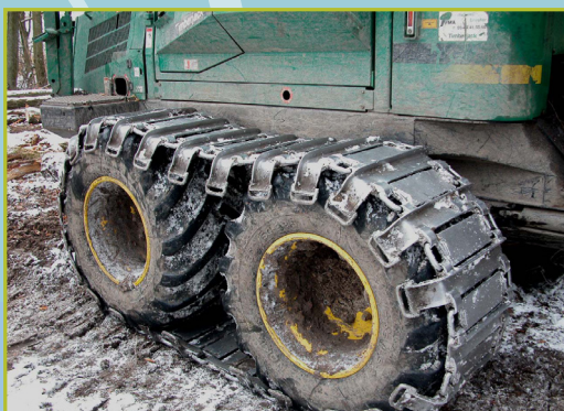
> Dispositif de « tracks fermés » installé sur un porteur (Y. Lefèvre - INRA)
