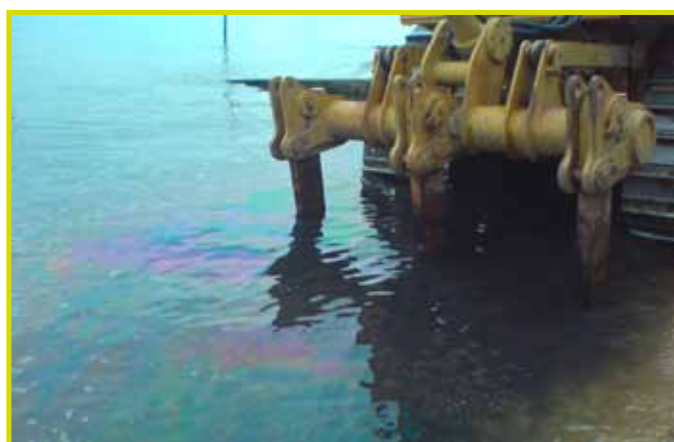
Les risques de fuites d'huile ou de carburant des engins de chantier sont relativement élevés. Une surveillance est nécessaire afin de les maîtriser. (Photo : X. Bodin)
